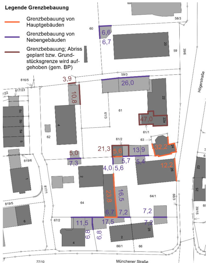
Abb. 10 vorhandene Grenzbebauungen im Plangebiet, ohne Maßstab
